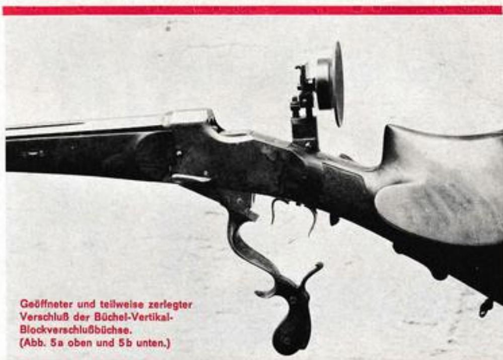
Geöffneter und teilweise zerlegter Verschluß der Büchel-Vertikal-Blockverschlußbüchse. (Abb. 5a oben und 5b unten.)
