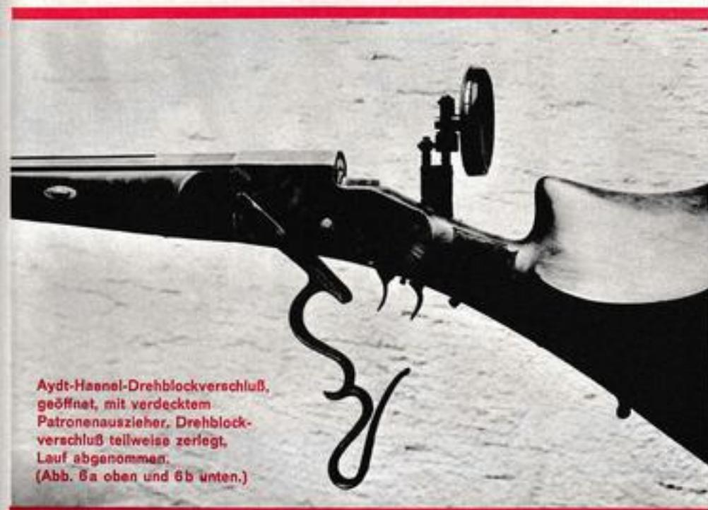
Aydt-Haenel-Drehblockverschluss, geöffnet, mit verdecktem Patronenauszieher. Drehblockverschluss teilweise zerlegt, Lauf abgenommen. (Abb. 6a oben und 6b unten.)
