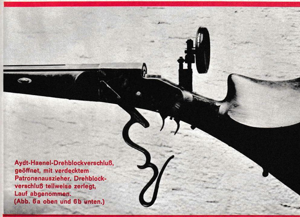
Aydt-Haenel-Drehblockverschluß, geöffnet, mit verdecktem Patronenauszieher. Drehblockverschluß teilweise zerlegt, Lauf abgenommen. (Abb. 6a oben und 6b unten.)
